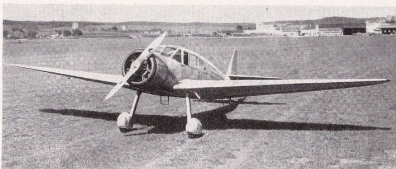
Klemm KL 36 mit 220-PS-Siemens-Motor, das schnellste Klemm-Flugzeug. Im Hintergrund der Flughafen Böblingen (1938)
